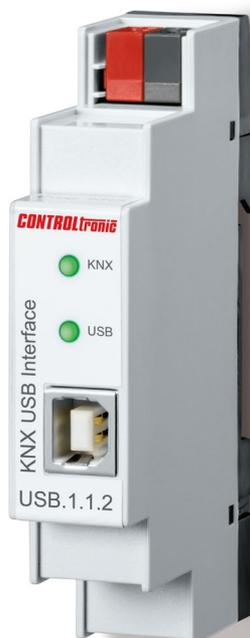
Das KNX USB Interface dient als Datenschnittstelle zwischen einem PC oder Notebook und dem KNX-Bus. Es kann als KNX-Programmierschnittstelle mit der ETS verwendet werden und unterstützt dabei KNX Long Frames. Diese ermöglichen einen schnelleren Download in Geräte, die KNX Long Frames unterstützen.
